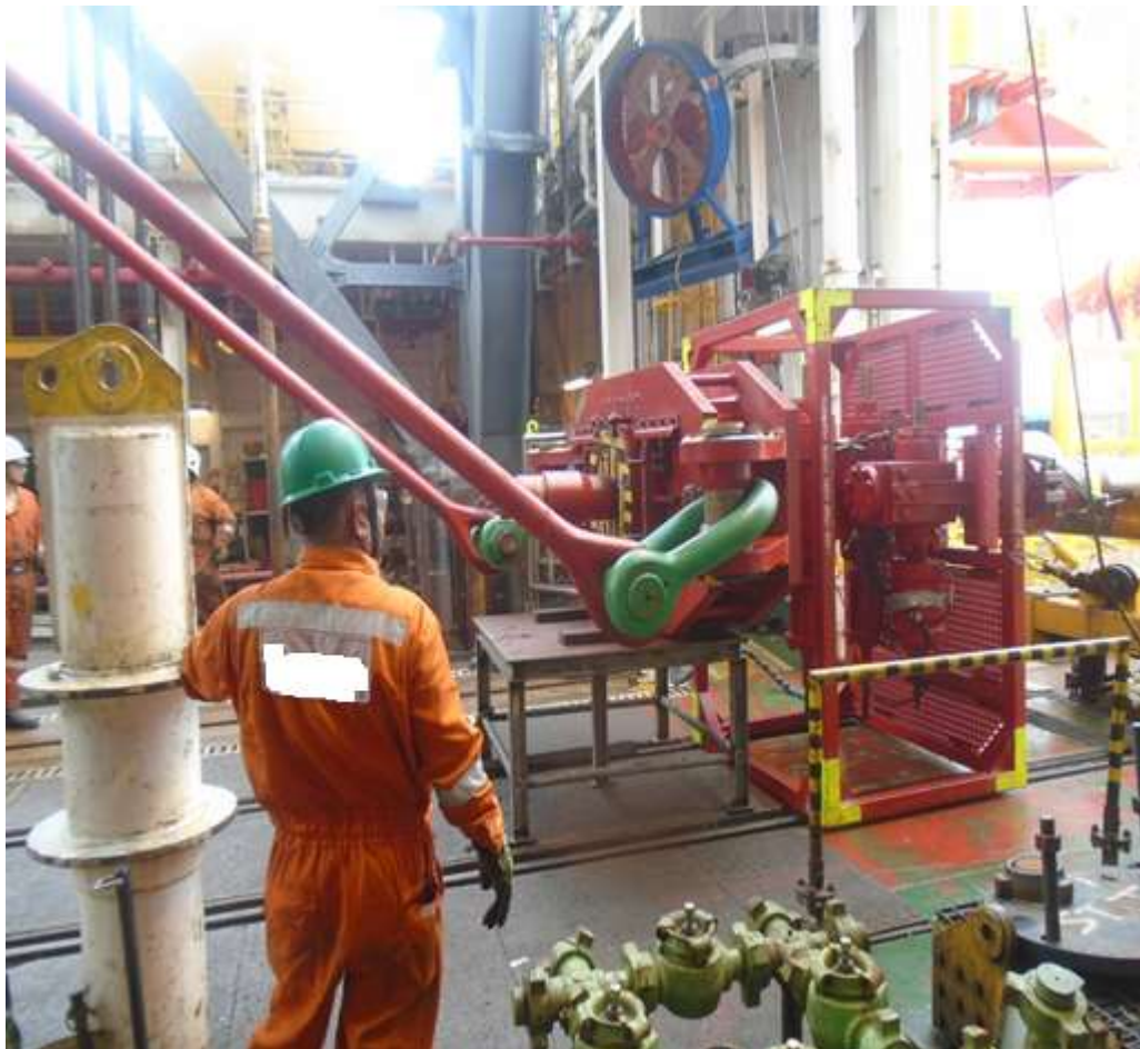
Figura 1 – Altura do frame da SFT deve permitir a montagem do EBE apoiado sobre sua mesa de suporte
