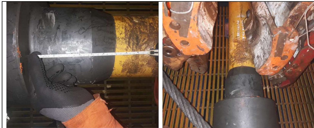
Figura 2 – Interferência entre elevador BX da sonda e o pescoço da SFT
