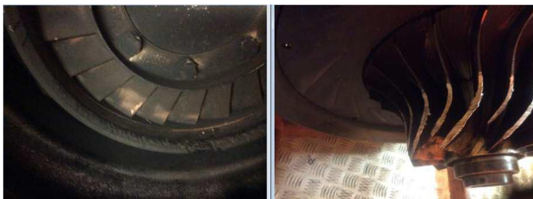
Figura 31: Componentes danificados da turbina
