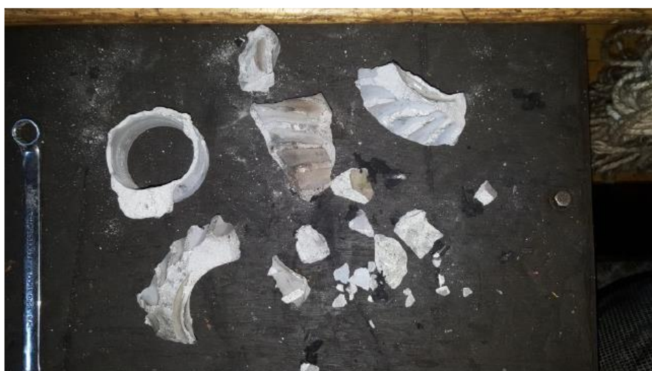
Figura 32: Pedacos desintegrados do impedor retirados na admissão de ar do turbocharger.
