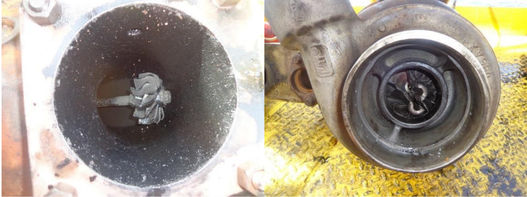
Figura 33: Eixo onde originou a falha do turbocompressor defeituoso.
