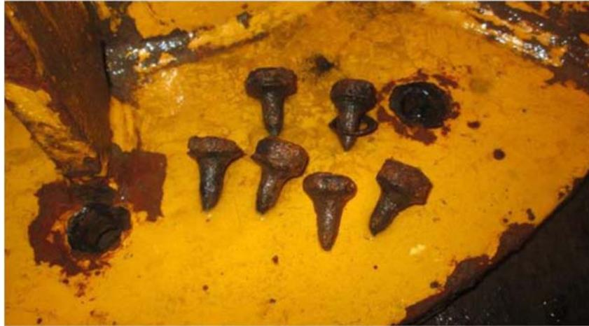
Parafuso falhados por corrosão<sup>3</sup>
