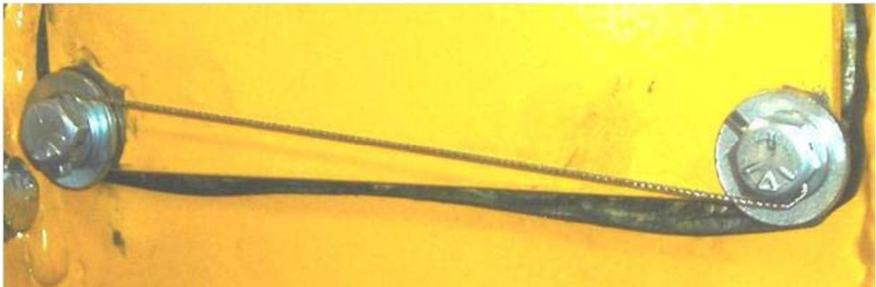
Arame de freno pré-fabricado instalado<sup>3</sup>
