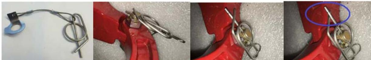
(1) Kit; (2) Instalado não travado; (3) Travamento "mola"; (4) Travamento mecânico
