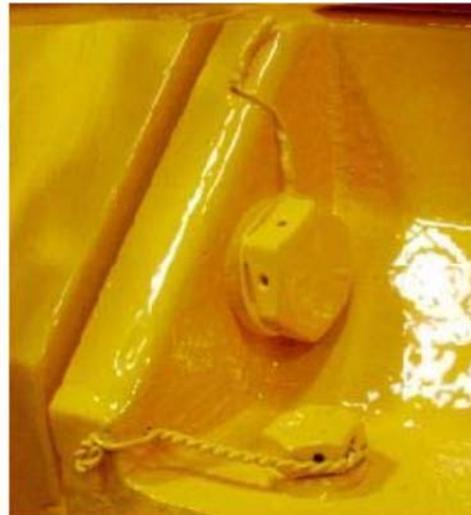
Arame de freio instalados<sup>3</sup>
