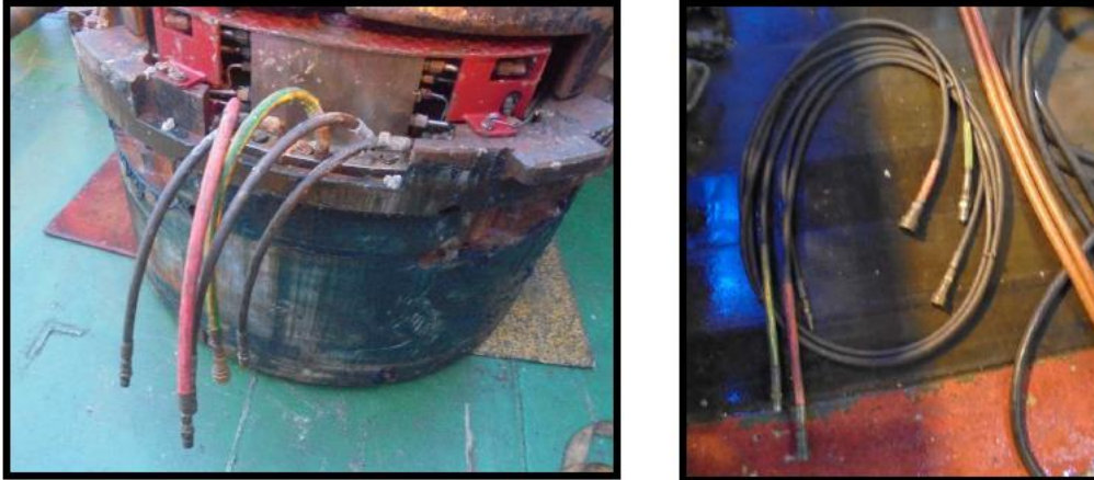
Figura 09 - Identificação de mangueiras e conexões
