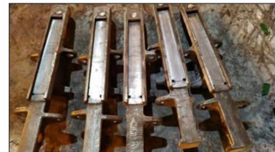
Figura 02 - Segmentos de cunhas condenados
